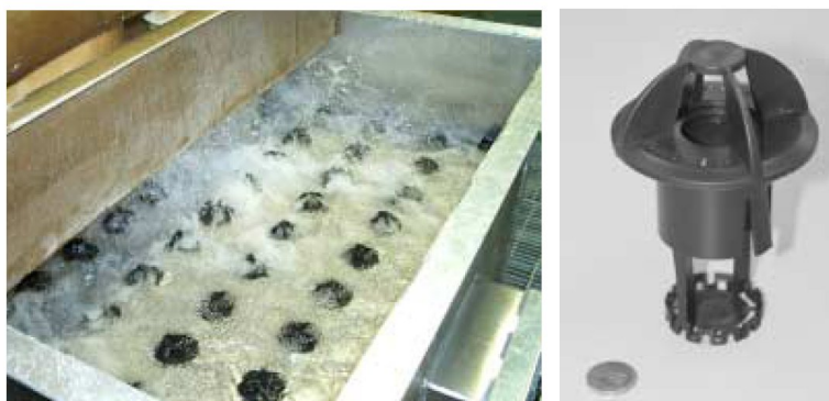
Mynd 1.15: Hægra megin er mynd af kórónu-nosslu frá LS Enterprises (Ft. Myers, Florida) Myndin við hliðina á er á stærð við krónu. Nosslurnar eru settar í gataplötu eins og sýnt er hægra megin. Hver nossla getur dreift um 40 L/min þegar vatnshæð yfir þeim er um 10 sm. Myndin er fengin frá Steve Summerfelt.
