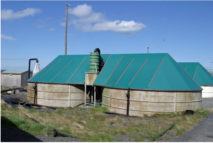
Mynd 3.10. Trefjaplastkór hjá Silfurstjörnunni (Ljósmynd: Valdimar Ingi Gunnarsson).
