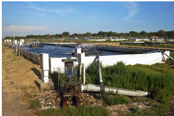
Mynd 3.13. Dúkklaett lengdarstraumskar á Ítalíu (Ljósmynd: Valdimar Ingi Gunnarsson).
