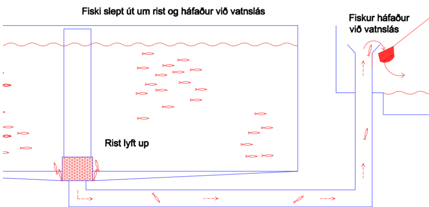
Mynd 4.33. Dauður fiskur losaður út um frárennsli með að lyfta upp rist hjá Íslandsbleikju á Stað (Teikning: Guðmundur Einarsson).
