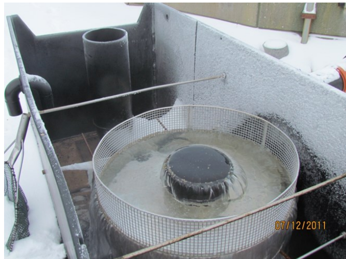
Mynd 4.35. Dauður fiskur losaður út um fiskirör hjá Íslandsbleikju á Vatnsleysu upp í fiskgildru sem er við hlið karsins (Ljósmynd: Guðmundur Einarsson).
