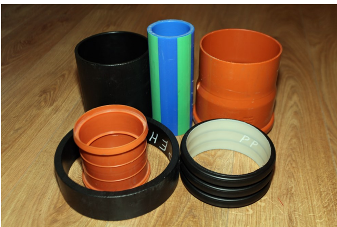
Mynd 4.3. Nokkrar gerðir af vatnslögnum. Fremst til hægri er barkarör, þar fyrir aftan er PVC “óranslituðu” rör. Svörtu rörin til vinstri eru PE vatnslagnir (Ljósmynd: Valdimar Ingi Gunnarsson).
