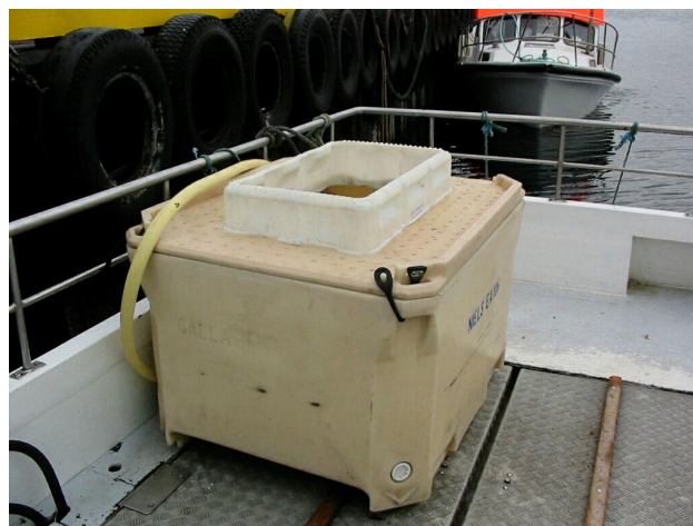
19. mynd. Fiskikar með karmloki til að auðvelda losun í kar.
